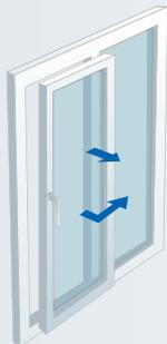
Este sistema possui um encaixe especial que faz com que a lâmina deslize em carris.
